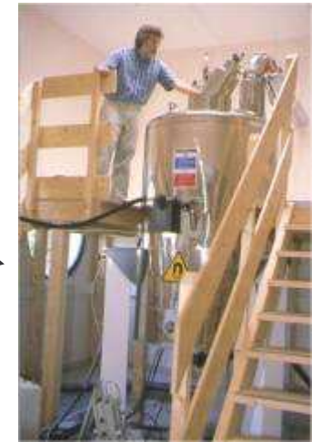
NMR Spectroscopy (800 MHz) : CEA
